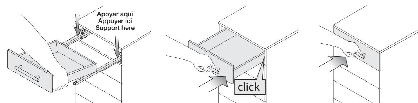
Démontage de la façade / Disassemble front
