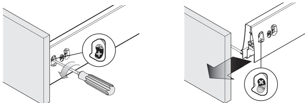
Montage de la façade / Assemble front
